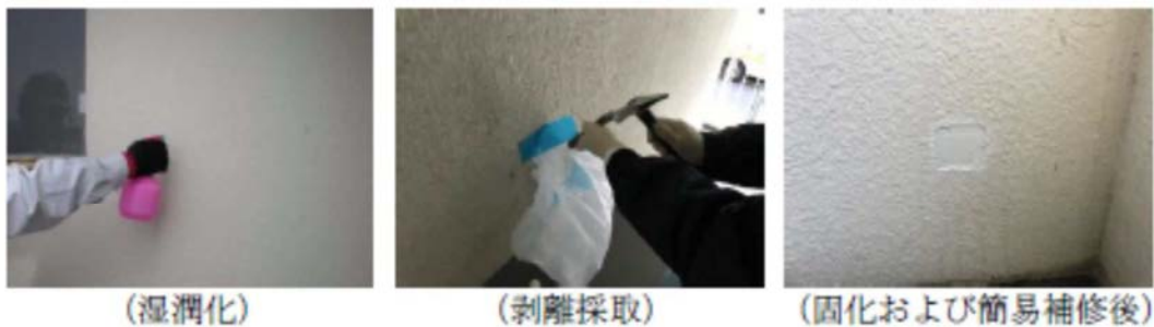
図-10 サンプルング例（建築用仕上塗材等）
