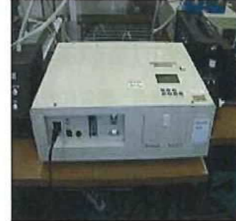
図-36 繊維状粒子自動計測器の例 リアルタイムモニター
